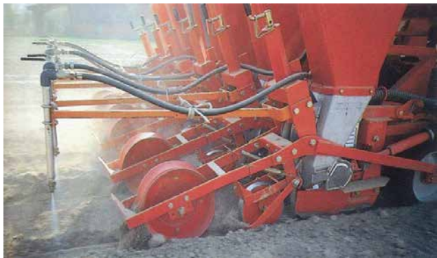
Figura 8 Macchina seminatrice con ugelli per il trattamento localizzato lungo la fila.
